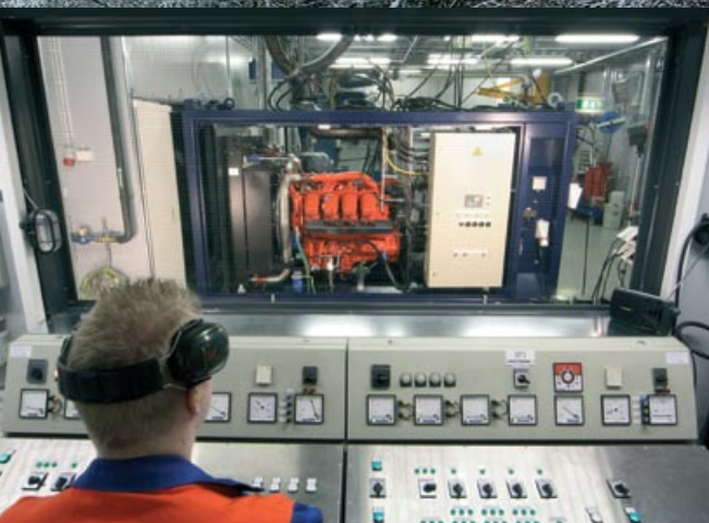
Перед отправкой каждая дизельная электростанция и насосная станция полностью проверяется и испытывается на полную мощность на современном стенде.
